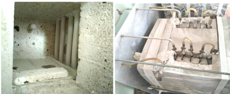
Рисунок 1 – Расположение нагревателей в камере печи и система продувки нагревателей аргоном (вид сверху печи)
