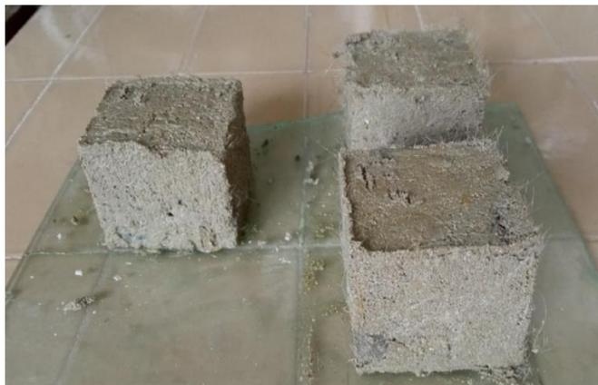
Рисунок 2 – Образцы бетона армированного полимерным фиброволокном
