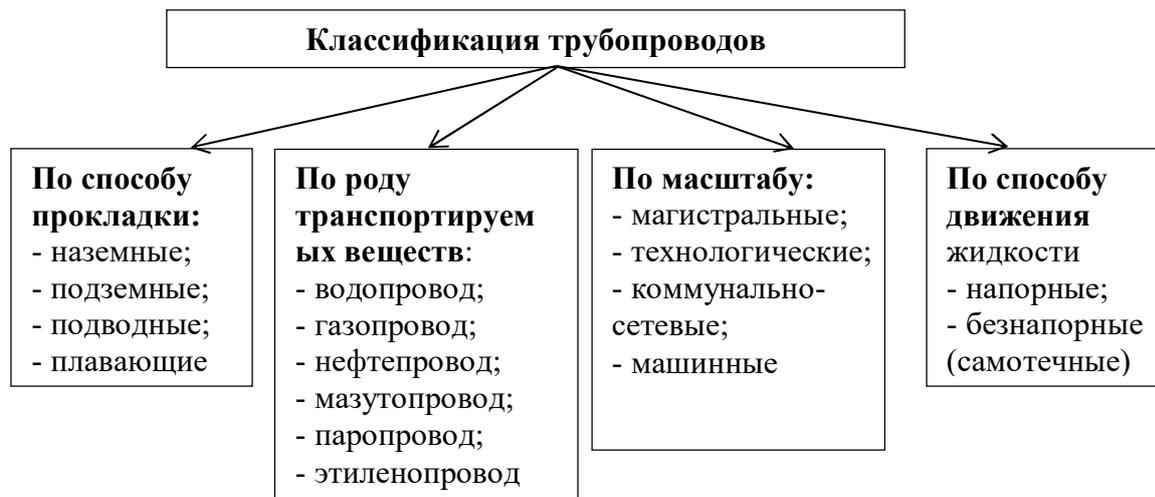
Рисунок 1 - Классификация трубопроводов
