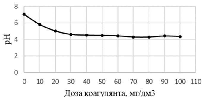
Рисунок 2 – Влияние дозировки коагулянта сульфата алюминия на pH в осветленной воде
