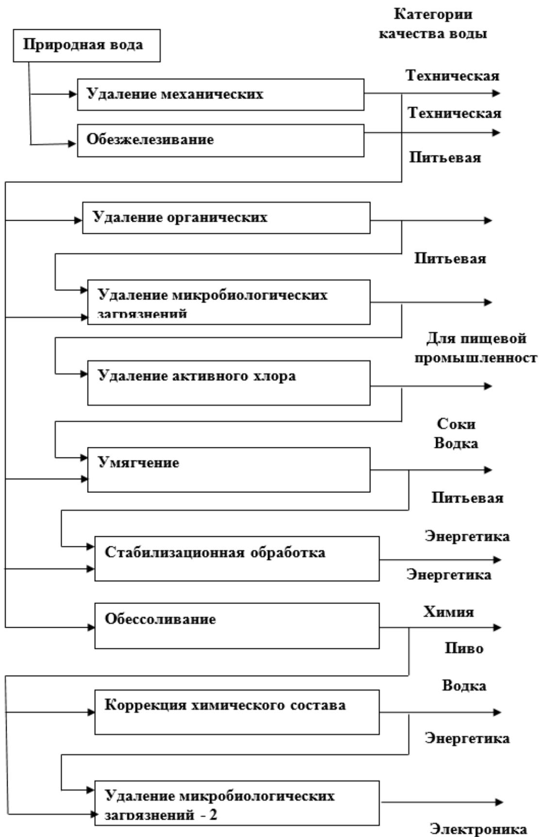
Рисунок 1– Основные приемы водоподготовки
