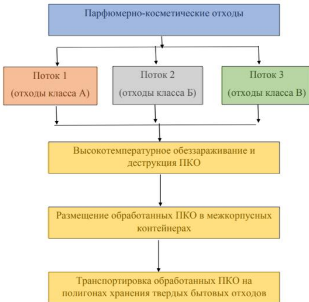
Рисунок 1 – Способ сбора и высокотемпературного обеззараживания парфюмерно-косметических отходов, содержащих быстроразлагаемые (биоразлагаемые) органические вещества
