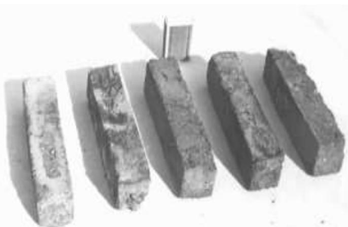
Рисунок 2 – Отвержденные образцы осадков шахтных вод
