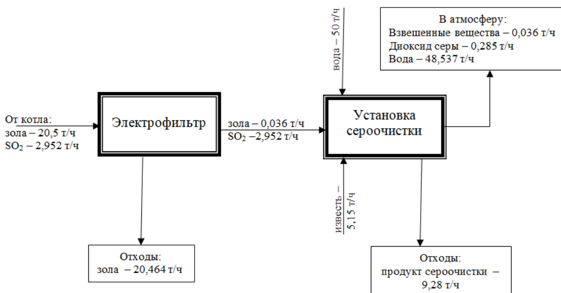
Рисунок 2 – Схема материального баланса установки очистки дымовых газов котла
