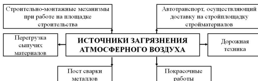
Рисунок 1 – Основные источники загрязнения атмосферы в период строительства
