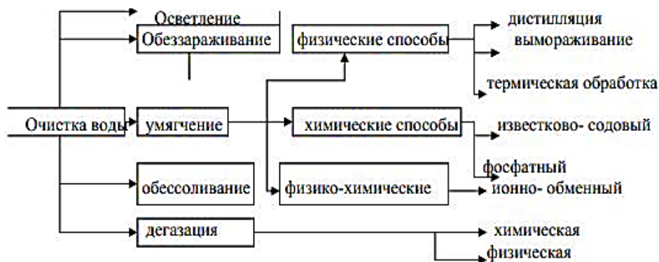
Рисунок 1 - Схема промышленной водоподготовки
